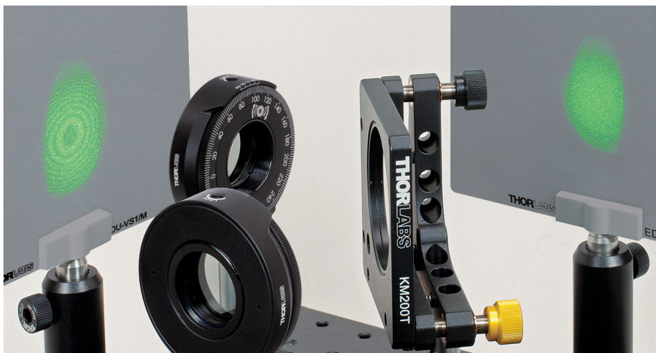
Figura 14 Tela Direita: Nenhum Padrão de Interferência. Tela Esquerda: Padrão de Interferência atrás da Borracha
