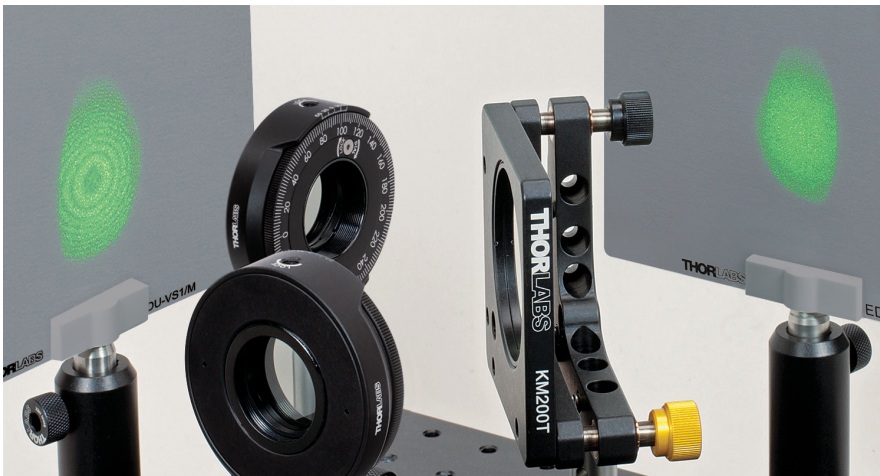
Abbildung 14: Rechter Schirm: kein Interferenzmuster beobachtbar, Linker Schirm: Interferenzmuster hinter dem Radierer
